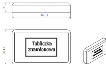
Wzór N Transponder nie-atex do montażu metodą klejenia
